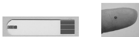
図5 血糖値センサの外観写真と必要血液量イメージ (センサ： 30\times 7\times 0.7\text{ mm} 平板チップ型、血液量： 0.6\text{ }\mu\text{L} )
