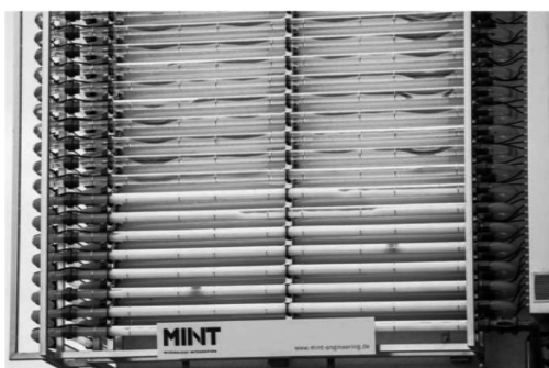
図2. MINT Engineering GmbH ベルリン本社に設置されたフォトバイオリアクター
