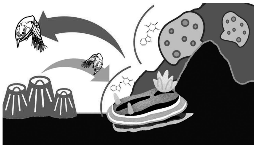
図2. 海洋付着生物による付着阻害機構の模式図
